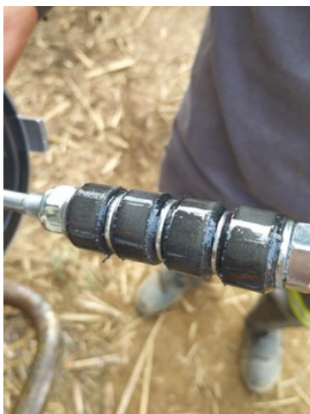
Figura 4 : Material metálico encontrado no sistema; Figura 5: Material metálico em um pano que foi utilizado para limpar a haste magnética;
