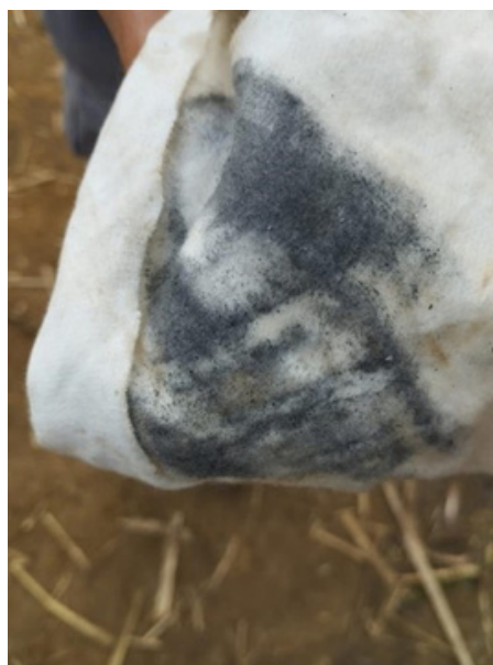
Figura 4 : Material metálico encontrado no sistema; Figura 5: Material metálico em um pano que foi utilizado para limpar a haste magnética;
